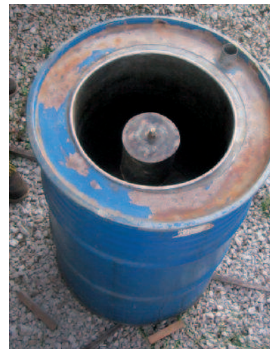
Uno dei primi metodi messi a punto: matrjoska di bidoni con intercapedine per bagnomaria.
